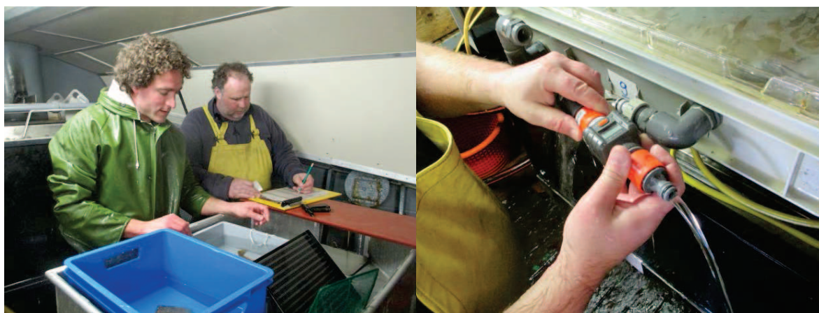
Figuur 4. Opstelling aan boord; links: Opstelling voor het scoren van vitaliteit en beschadigingen. Rechts: Stroommeter gebruikt om de toevoer snelheid van vers zeewater te controleren.
