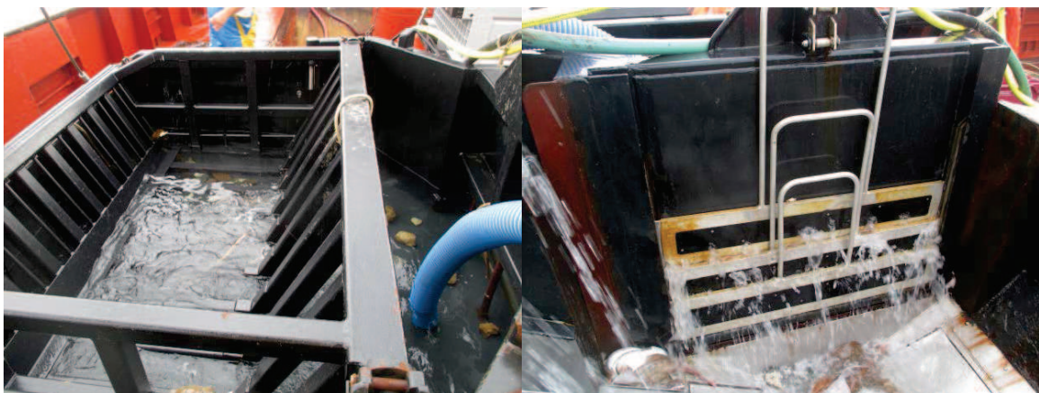
Figuur 17. Nieuwe stortbak GO31. Links: Stenenvanger met water in de bak. Rechts: Schuiven bij de overloop naar de opvoerband.
