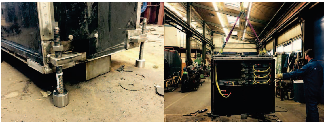
Figuur 26. Aanpassingen aan de bakkenunit. Links: Stelpoten om de bakkenunit waterpas te kunnen neerzetten. Rechts: Hijsogen, vasthoudbeugels en een sprankel om de bakkenunit op te kunnen hijsen.
