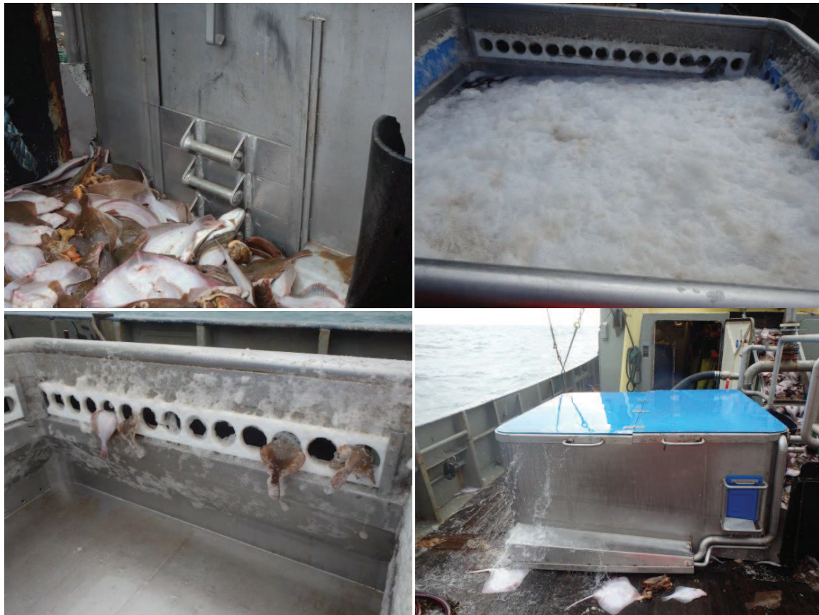
Figuur 19. De nieuwe stortbak van de GY57. Linksboven: schuiven om de opvoer van vis te reguleren. Rechtsboven: stortbak vol met vis en water (en schuim). Linksonder: de ontsnappingsgaten voor ondermaatse vis. Rechtsonder: de stortbak in werking.
