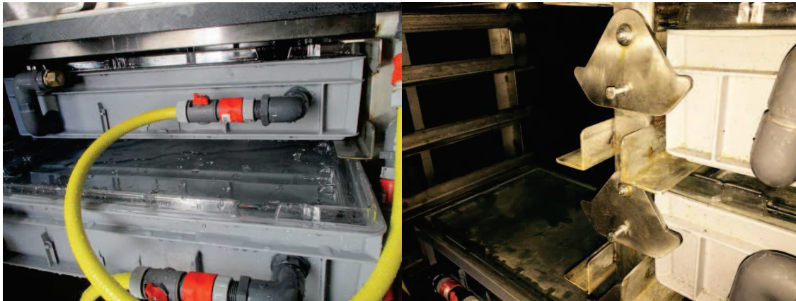
Figuur 27. Aanpassingen aan de bakkenunit. Links: Kraantjes op de watertoevoer en pluggen op de waterafvoer tijdens transport. Rechts: Wervels om de bakken op de plek te houden.
