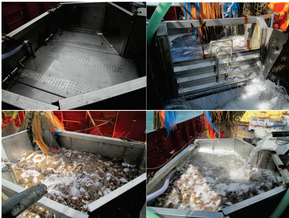
Figuur 18. De nieuwe stortbak van de GO23. Linksboven: Gaten in de vloer voor luchtinvoer. Rechtsboven: Schuiven voor geleidelijke opvoer van vis. Linksonder: Reguliere stortbak vol met vis, water wordt van bovenaf toegevoegd. Rechtsonder: Nieuwe stortbak vol met vis en water, de watertoevoer zit links op de bodem in de hoek, echter was deze soms onvoldoende en werd de oude watertoevoer bijgezet om het waterniveau te handhaven.
